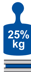
Vodorovná montáž = 25 % uvedené nosnosti
