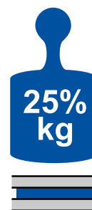
Montaż poziomy = 25 % podanej nośności
